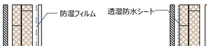
a.断熱材の継ぎ目にテープ貼り b.断熱材の室内側に防湿フィルム張り c.断熱材の屋外側に透湿防水シート張り
