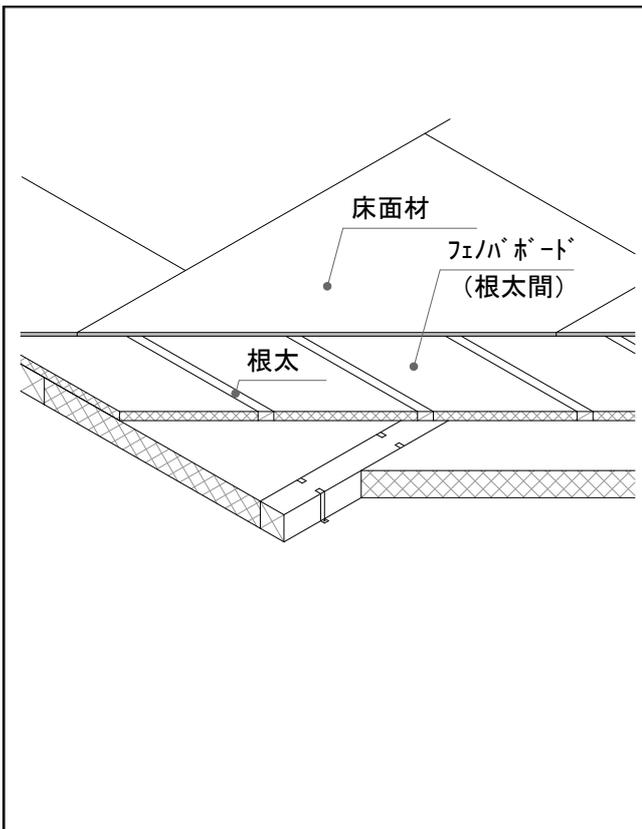
③根太施工～⑤床面材施工
