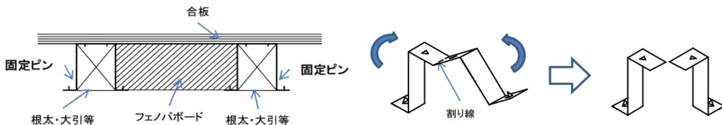
固定ピンを大引・根太等に所定のの間隔（600mm以下、フェノバード端部からは300mm以下）でハンマー等で軽く叩いて固定します。
